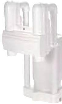
„SK 2“ **Einhängeskimmer** aus ABS. Diese Modelle können sehr variabel an Aufstell- oder anderen Schwimmbecken installiert werden. Die Filterfläche des Filterinnenteils beträgt 1,5 m<sup>2</sup> (nur bei Modellen mit Filterinnenteil). Wahlweise verklebt oder unverklebt lieferbar. Bei der unverklebten Variante (zur Befestigung am Betonbeckenrand oder ähnlichem) werden 2 Rohre á 30 cm benötigt.
