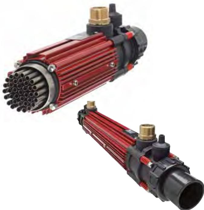
Der Electro Wärmetauscher wird in den Poolfiltrationskreis eingebaut, von dem aus Wasser durch den rohrseitigen Bereich des Wärmetauschers geleitet wird. Das Wasser des Primär-Heizkreises fließt im Gegenstrom durch den mantelseitigen Bereich des Wärmetauschers und heizt so das Wasser des Swimmingpools auf.
