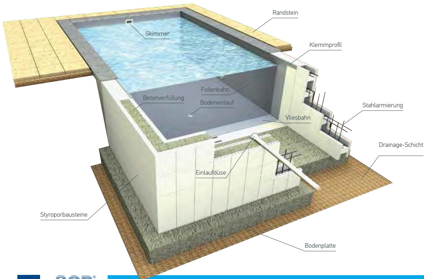
Die aus EPS (Polystrol) bestehende Beckenschalsteine verbleiben nach dem Bau im Erdreich und dämmen es beidseitig.
