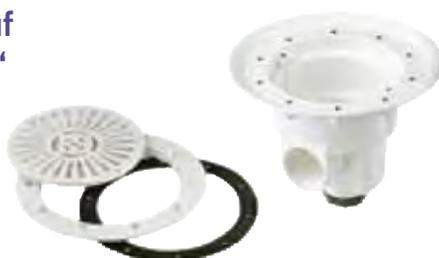
Für Folienbecken. Mit synthetischen Klebedichtungen und Schraubensatz aus Edelstahl. Seitlicher Abgang 2“ und nach unten Abgang 1 ½“ der von innen zur Druckprüfung verschlossen werden kann. Saugleistung 0,5 m/s. Maximal empfohlene Durchflussmenge: 13 m<sup>3</sup>/h. Zur kompletten Entwässerung bündig mit Beckenboden installieren.
