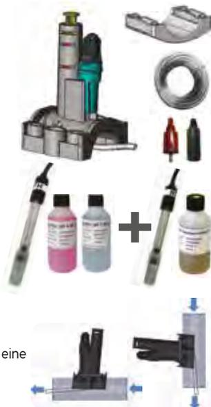
**Inklusive** einer 2in1-Sondenhalterung für eine vertikale oder horizontale Platzierung.
