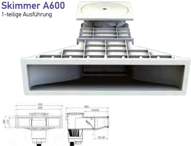
Dieses Modell ist das größere nach dem A400 Skimmer und mit einer Saugöffnung von 635 mm ausgestattet. Durch die Messingeinsätze ist eine sichere Montage des Flansches möglich. Die Saugöffnung gibt es bei ABS, wie bei allen anderen Modellen, in verschiedenen UV-beständigen Farben oder mit rostfreien Edelstahl.
