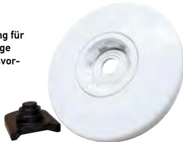
Für Folienbecken aus ABS. Mit Dichtungen und Kontermutter, R 2" außen, ø 50 mm innen, Multiflow-Kugel 14 mm kann auf 20 oder 25 mm vergrößert werden.
